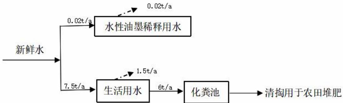
图 2.2-1 项目水平衡图 单位：m<sup>3</sup>/a
