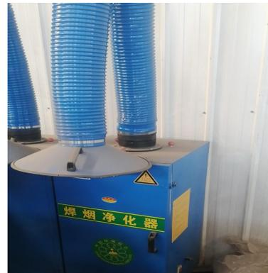
移动式焊接烟尘净化器
