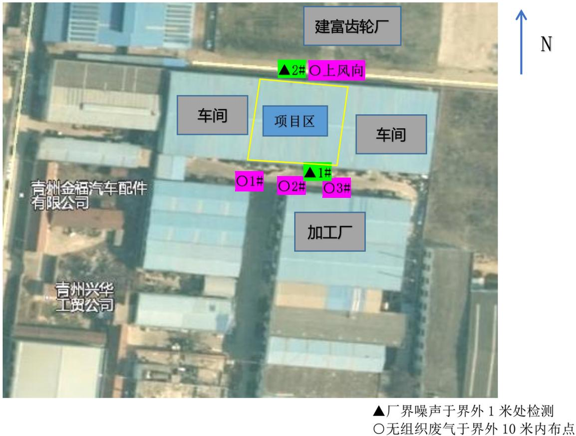
图 6-1 废气和噪声检测点位图
