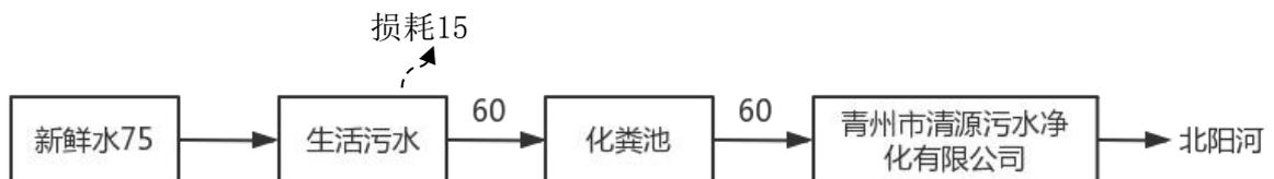
图2.2-1 项目水量平衡图 单位：m<sup>3</sup>/a
