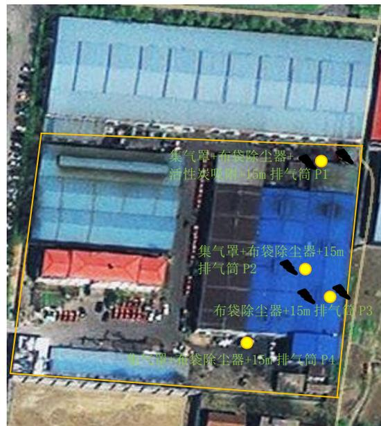
图 6-1 废气和噪声检测点位图
