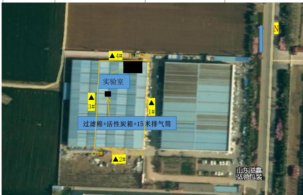
图 6-1 废气和噪声检测点位图
