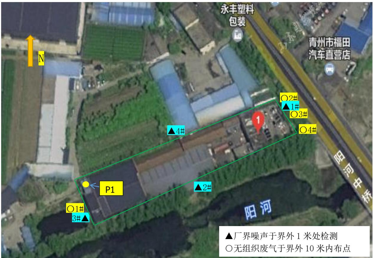
图 6-1 废气和噪声检测点位图
